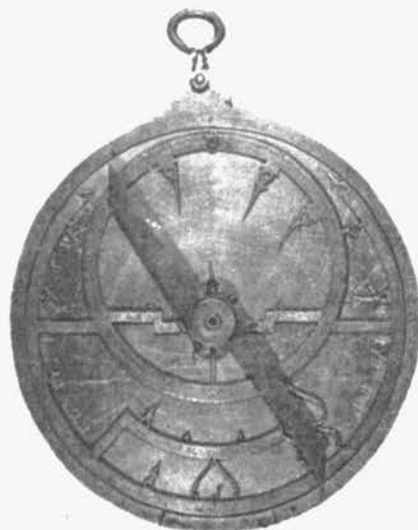
La investigación cultural y geográfico de la superficie del Globo realizada por los árabes sorprendió a los geógrafos modernos al traducirse la obra de aquéllos. En la lámina, astrolabio árabe. Ideado al parecer en el siglo II a.C. por Hiparco de Alejandria, fue perfeccionado por los árabes. Se usaba en astronomía y en la navegación para medir la altura de los astros. Fue sustituido por el sextante a fines del siglo XVIII.
