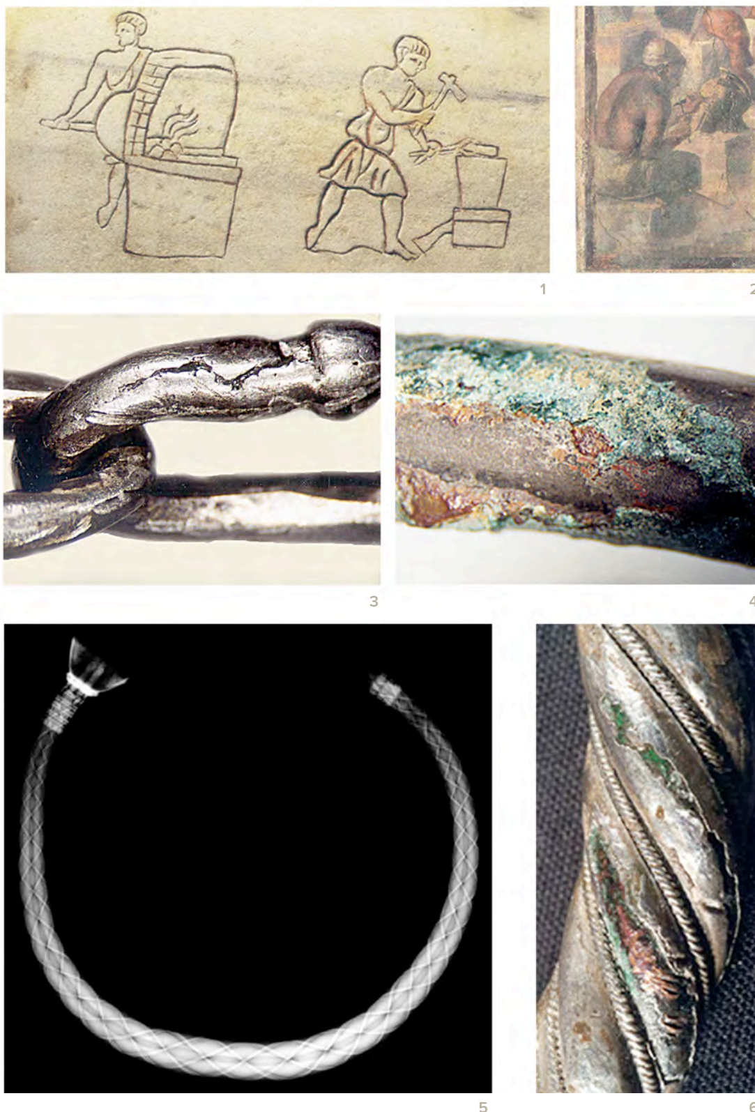
Fig. 1. Alteraciones debidas a la composición y técnicas de fabricación.
