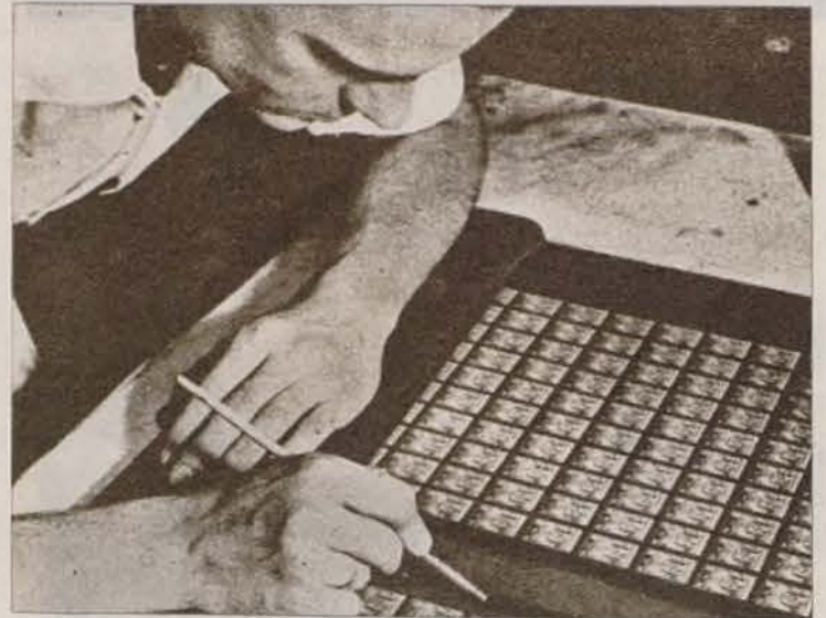
Preparación de clichés para la estampación de efectos timbrados.
