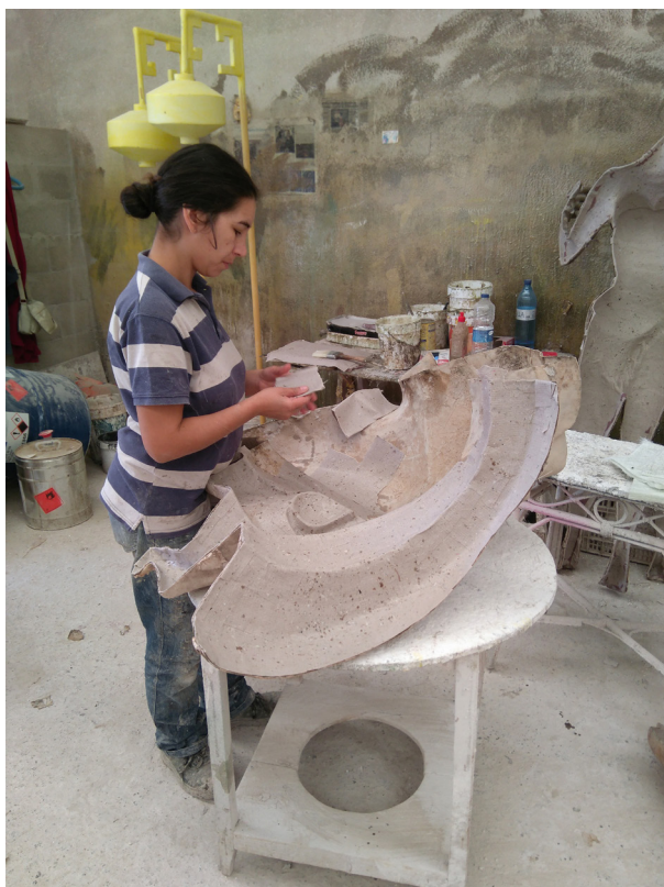
Figura 5. Proceso de colocación del cartón en el molde.
