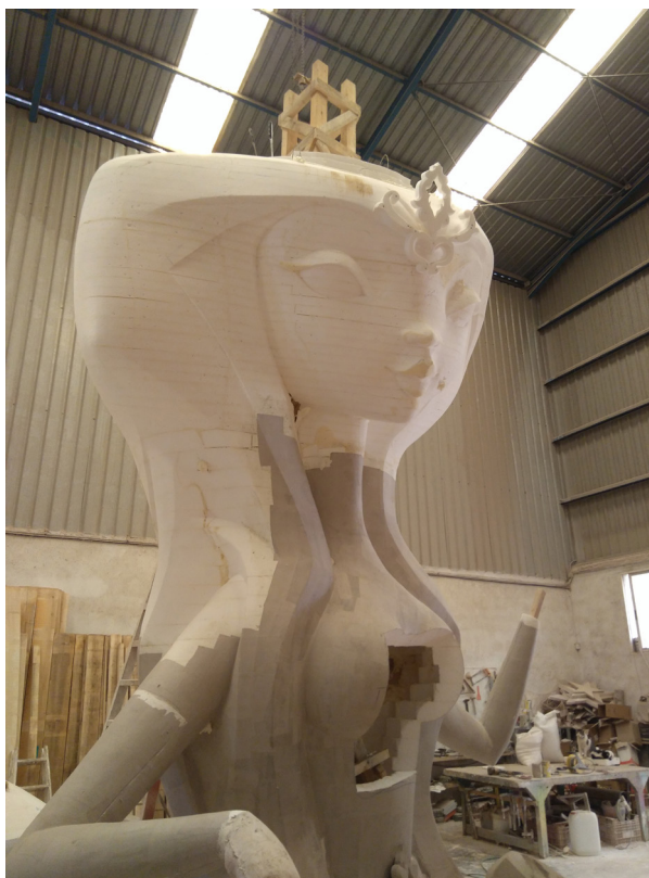
Figura 7. Construcción de una falla elaborada en corcho blanco: proceso de empapelado con cartón y superposición de las planchas de corcho para su tallado. Falla Islas Canarias-Trafalgar, 2017, del artista Lorenzo Fandos.
