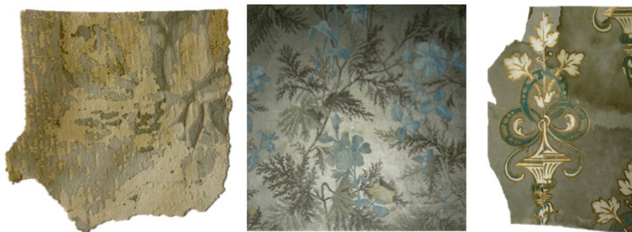
Figura 12. Detalle de algunos de los papeles pintados empleados en los revestimientos de la sala 06. De izquierda a derecha, el primero sería el utilizado en la fase IV, gofrado con una textura acanalada discontinua y pintado en color gris, verde y ocre. El segundo aparece en la fase V; de inspiración oriental presenta textura acanalada a modo de verjuras, con decoración pintada sobre fondo gris metalizado. El tercero es papel pintado mediante impresión en bloque en azul y blanco sobre fondo verde con perfiles dorados. Fotografía: Elsa M. a Soria Hernanz y Rosa Plaza Santiago.
