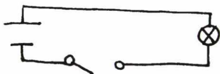
Esquema de un circuito eléctrico de foco.
