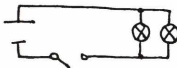
Esquema de un circuito eléctrico de candilejas.
