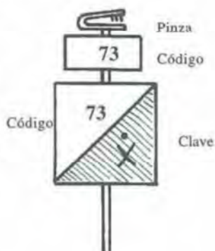
Ilustración n.º 8. Pintada, de cartón o de tela, la baliza siempre será un cuadrado dividido en diagonal por el blanco y el naranja.
