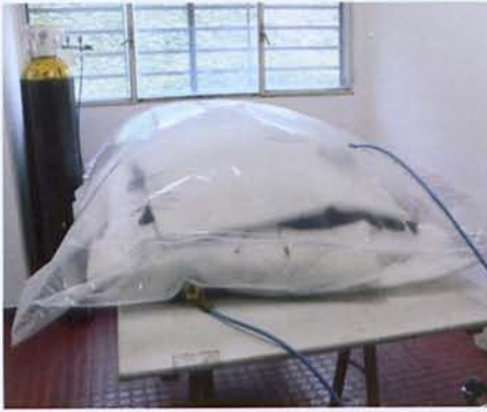
Figuras 18, 19 y 20. Fases del tratamiento de desinsectación por anoxia en bolsa estanca. Figures 18, 19 and 20. Stages of anoxic insect extermination treatment in an airtight bag.
