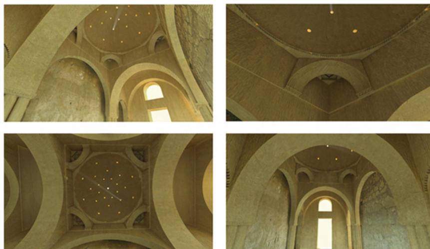
Fig. 8C Qasr Kharrane, Hab. 26. Hipótesis n°1: cúpula sobre trompas en arco. Reconstrucción Infográfica. Vistas tridimensionales.
