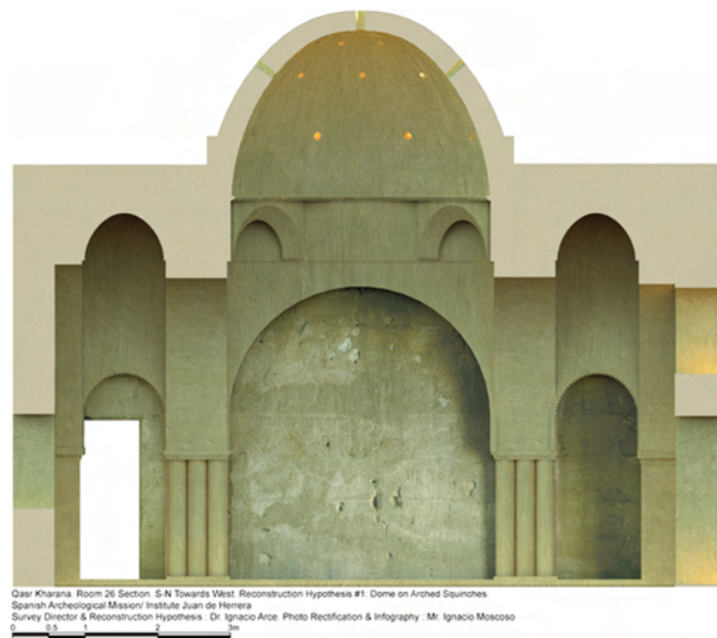
Fig. 8B Qasr Kharrane, Hab. 26. Hipótesis n°1: cúpula sobre trompas en arco. Reconstrucción Infográfica. Sección.
