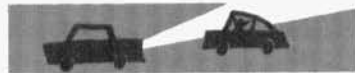
Si su luz de cruce alumbraba alto, deslumbrará a los conductores de los vehículos que circulan en dirección contraria.
