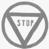
Obligación de detenerse en la intersección
