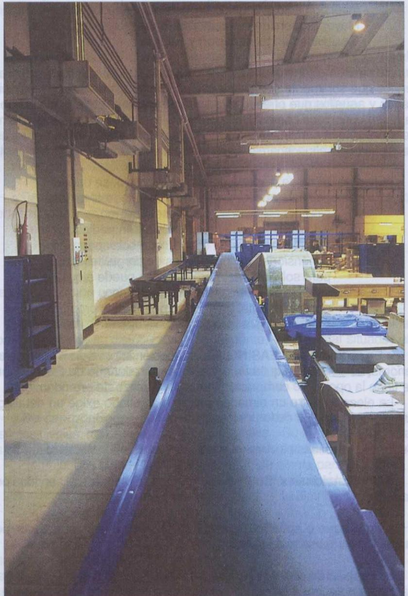
Cinta transportadora de un almacén semiautomatizado para el movimiento de los bultos.
