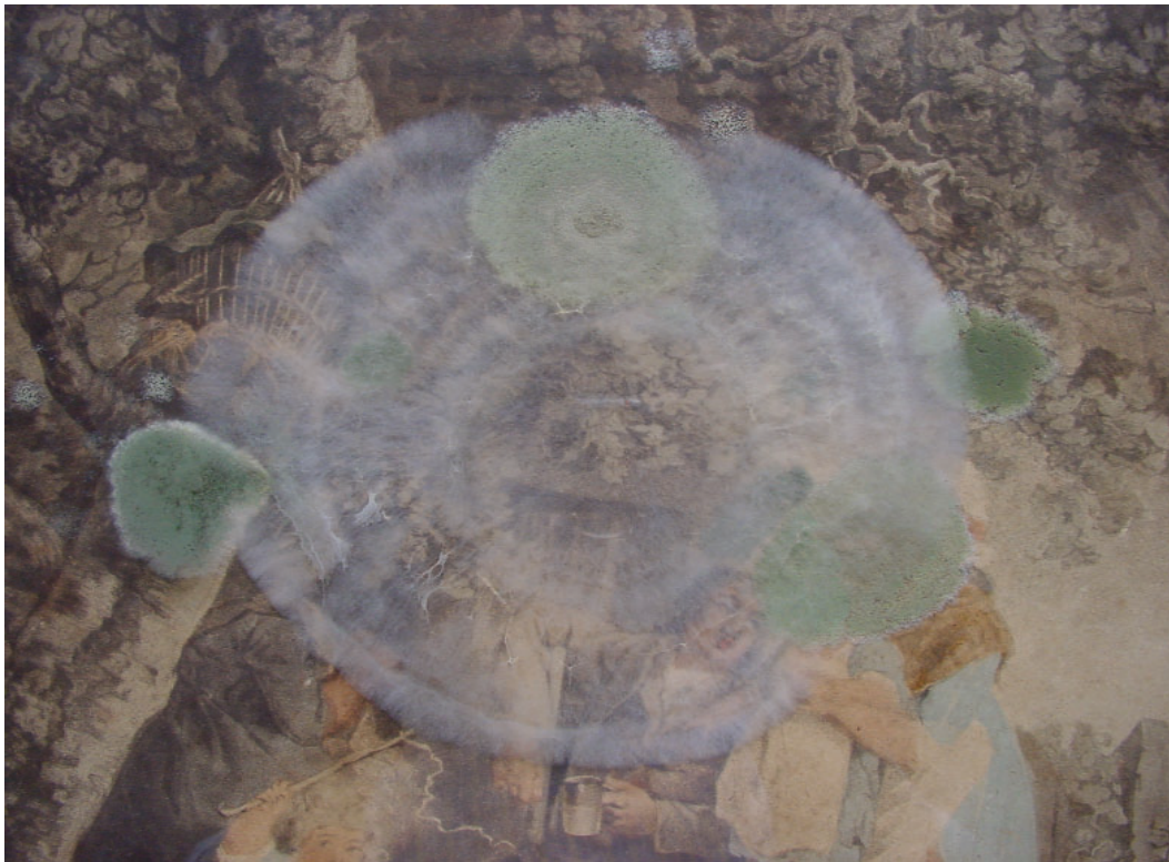
Fig. 8 Ataque de hongos. Fotografía: Eulalio Pozo.
