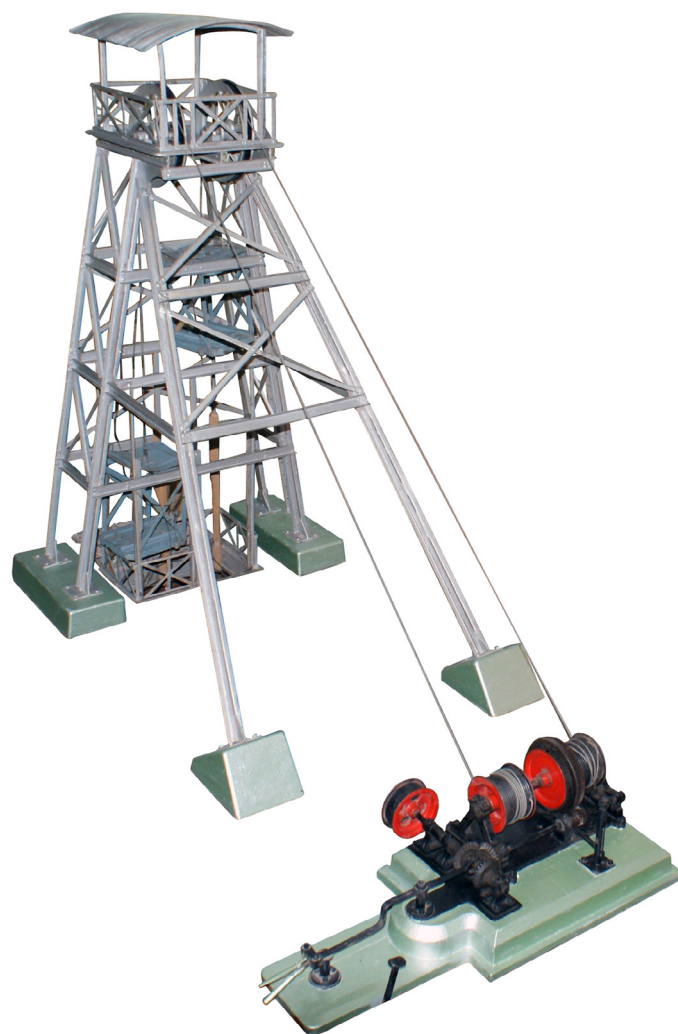
Figura 8. Castillete y máquina de extracción de dos jaulas. Fotografía: Jorge Luis Costafreda Mustelier.
