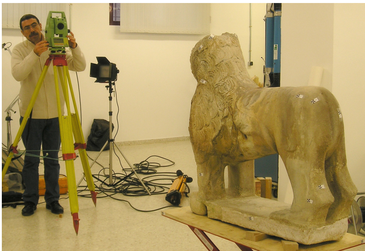
Figura 10. Toma de datos topográficos de los leones de la fuente de la Alhambra. Fotografía: J. M. Lodeiro, IPCE.
