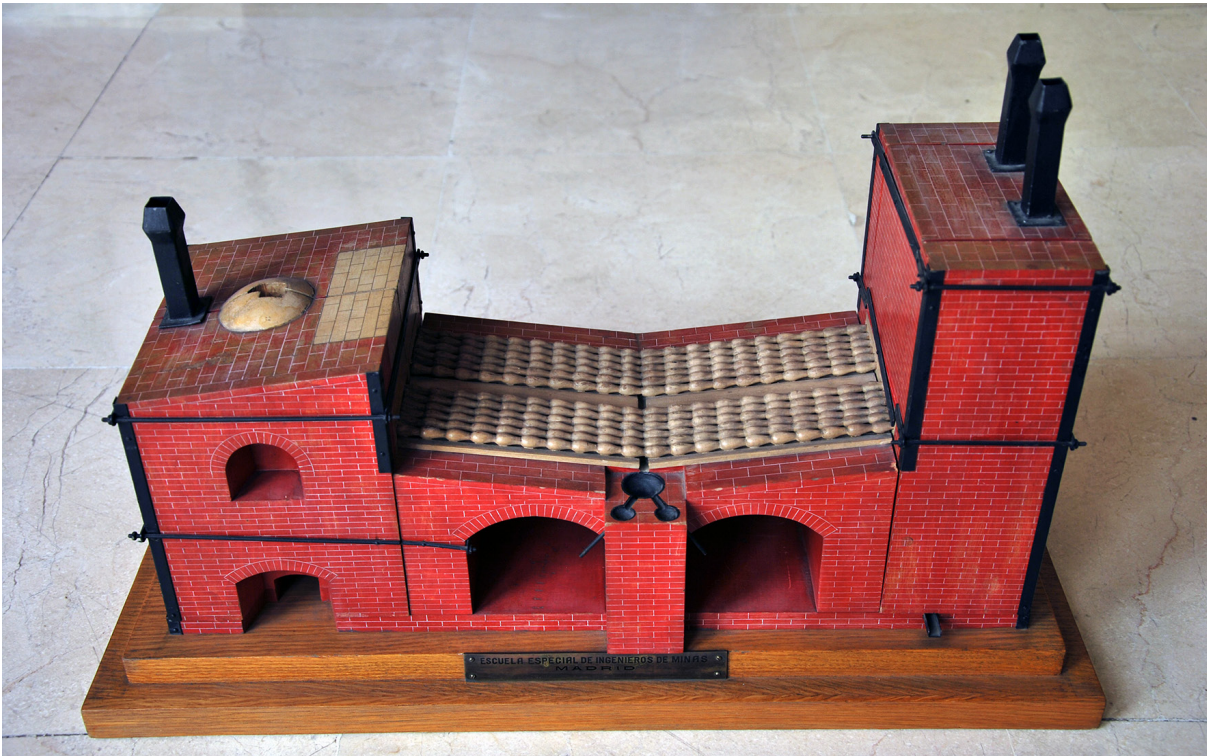
Figura 12. Horno de Bustamante o de aludeles. Fotografía: Javier Martín Blázquez.
