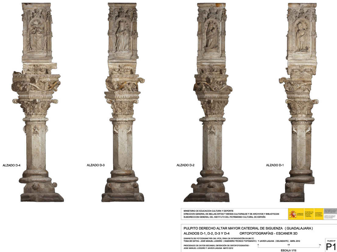
Figura 20. Ortofotos de los alzados del púlpito derecho de la Catedral de Sigüenza. Imagen: J. M. Lodeiro y Javier Laguna, Gabinete de Fotogrametría del IPCE.
