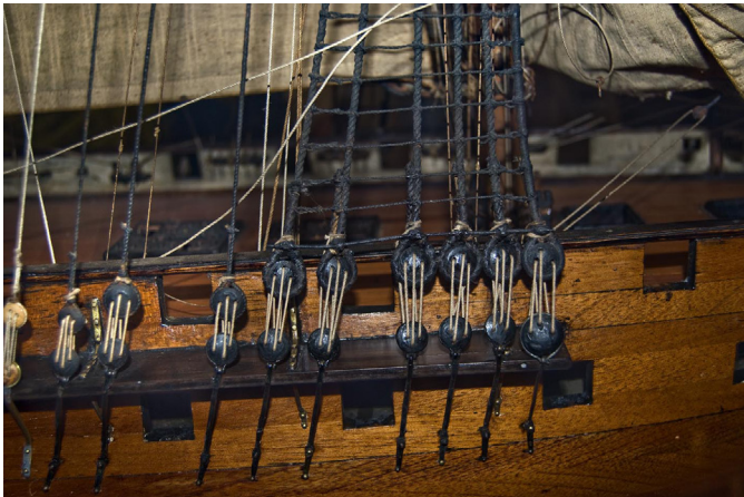
Figura 11. Restauración de la cabuyería, que respeta el color original del cáñamo. Fotografía: Jesús Herrero Marcos.
