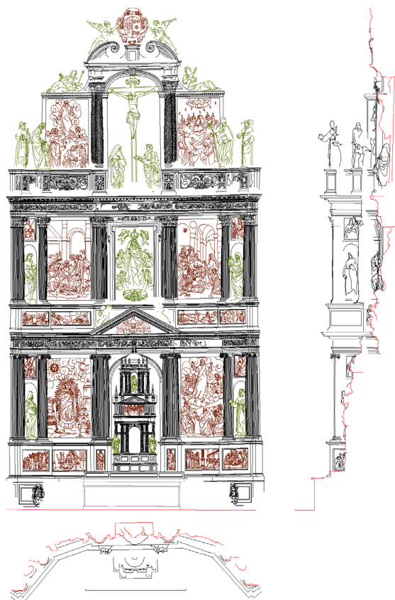
Figura 8. Restitución fotogramétrica del alzado del retablo mayor de la Catedral de Sigüenza. Imagen: J. M. Lodeiro y Susana Fernández, Gabinete de Fotogrametría del IPCE.
