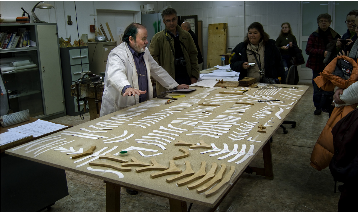
Figura 17. Despiece, en la mesa de gálibos, del modelo de la fragata Nuestra Señora de las Mercedes. Fotografía: Jesús Herrero Marcos.
