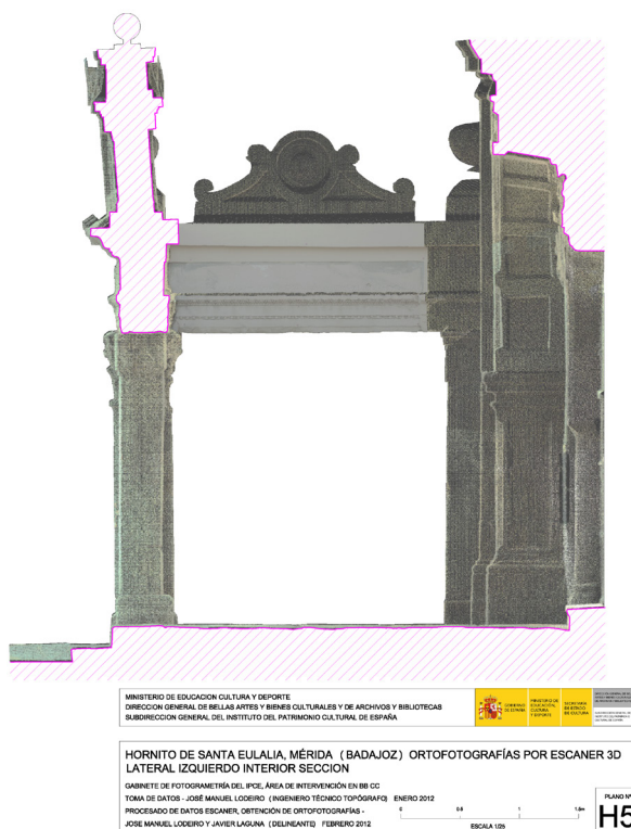
Figura 18. Plano con las ortofotos del Hornito de Santa Eulalia de Mérida a partir de nube de puntos mediante escáner láser 3D. Imagen: J. M. Lodeiro y Javier Laguna. Gabinete de Fotogrametría del IPCE.
