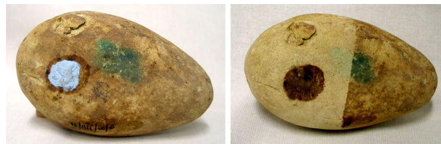
Fig. 53. Mancha producida en un material poroso cerámico por una masilla adhesiva, aparentemente adecuada para su uso museográfico (fot. MAN, Archivo Piezas restauradas , 41/2007/079).
