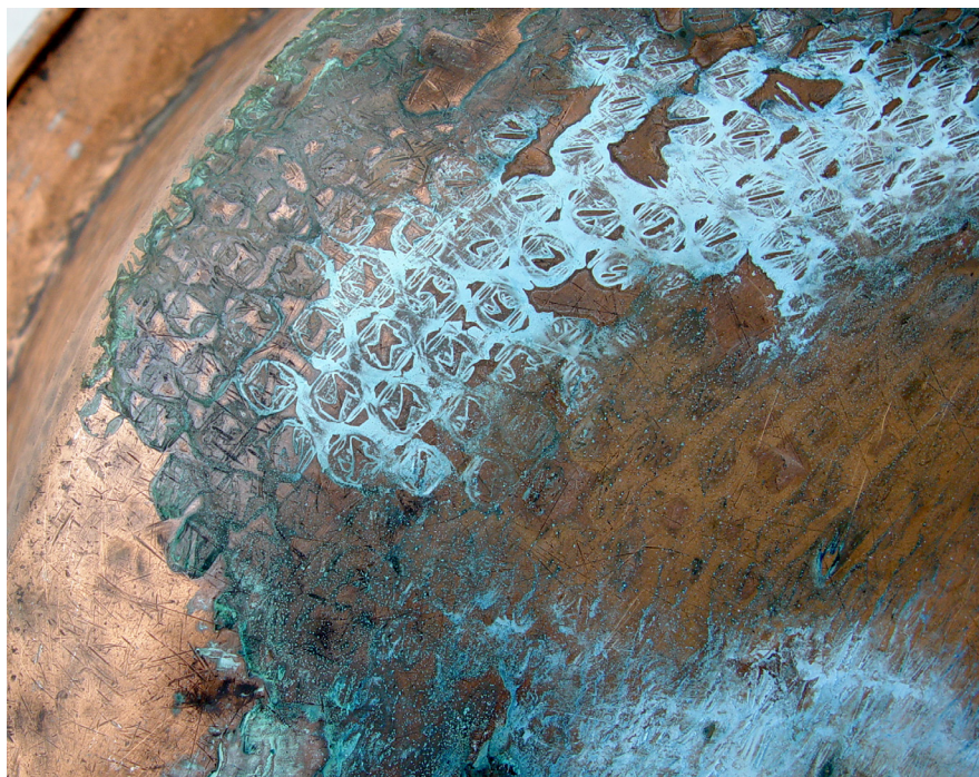
Fig. 50. Recipiente de cobre deteriorado por el contacto directo con plástico de burbujas (fot. Archivo personal).
