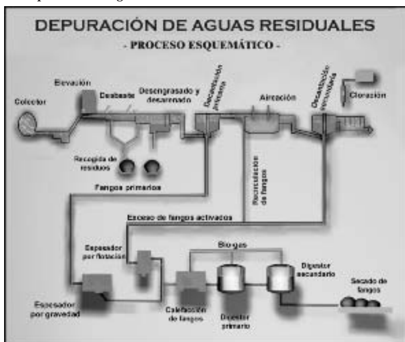
ESQUEMA 2.3: Depuración de aguas residuales
