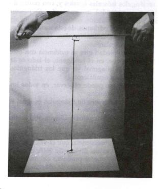
Se lleva la argolla hacia el extremo de la barra hasta que la goma quede muy tensa y, sin mover la barra, se suelta. La argolla se colocará en el punto de mínima elasticidad de la goma. Esa posición corresponde a la perpendicular con el tablero.
