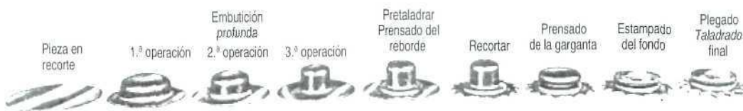
Cubo de rueda de aletas fabricado con prensa múltiple.
