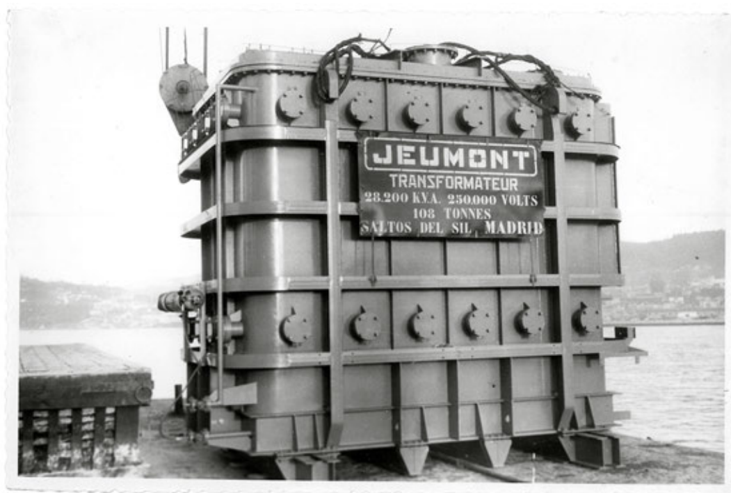
Figura 22. Transformador de alta tensión. Vigo. [s. f.]. Fotografía: Bene. Museo Arqueológico Provincial de Ourense.
