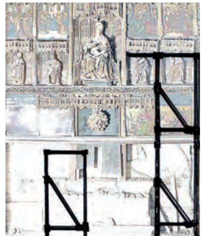
Dibujo y abajo, Imagen 7. Elementos modulares que, insertados unos sobre otros, permiten introducir la película radiográfica por la parte inferior del retablo. (Dibujos extraídos del cuaderno de campo).
