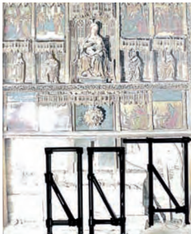
Dibujo y abajo, Imagen 7. Elementos modulares que, insertados unos sobre otros, permiten introducir la película radiográfica por la parte inferior del retablo. (Dibujos extraídos del cuaderno de campo).
