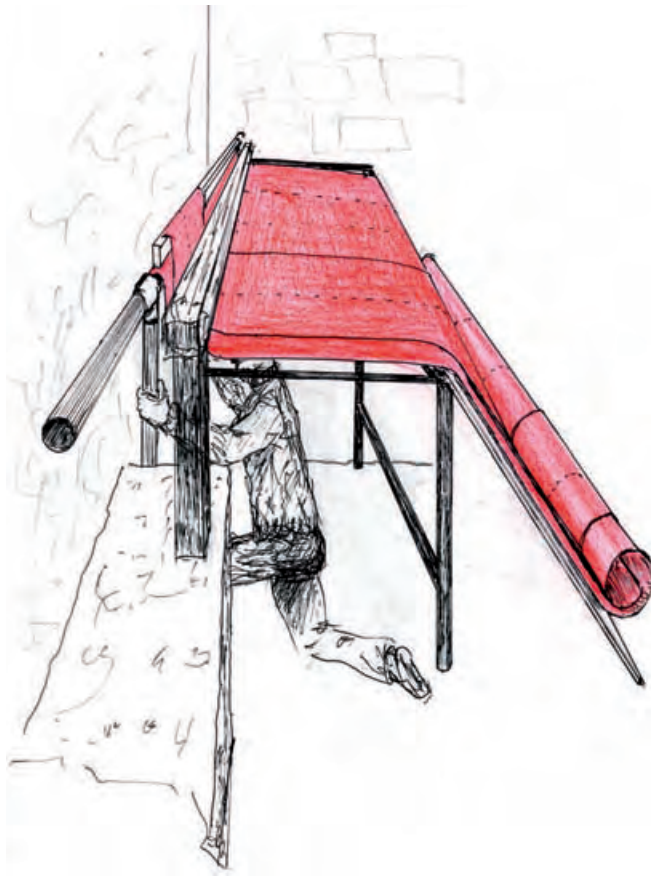
Dibujo y abajo, Imagen 7. Elementos modulares que, insertados unos sobre otros, permiten introducir la película radiográfica por la parte inferior del retablo. (Dibujos extraídos del cuaderno de campo).
