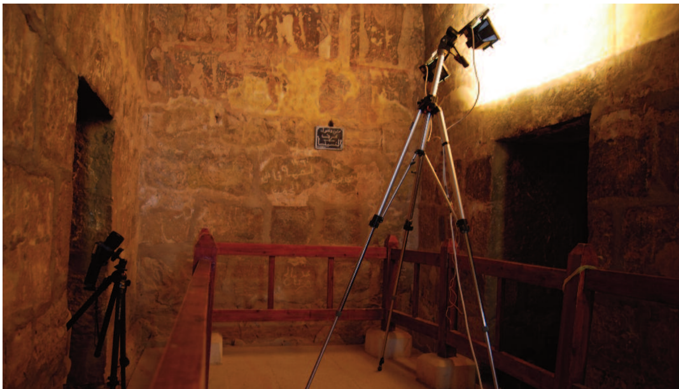
Fig. 3 Test de calentado de los muros mediante lámparas halógenas. A la izquierda puede verse la cámara termográfica.
