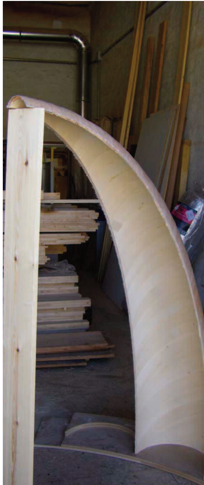
Fig. 15 (a,b y c) Cúpula gallonada para Hammam as-Sarraj construída con madera laminada y forro exterior de fibra de vidrio (que será recubierta con mortero de cal grasa con cocciopesto). Ha sido construída con la ayuda de un camión usado como molde para la prefabricación de cada gallón o gajo de la cúpula. Proyecto realizado en colaboración con el Dr. Enrique Nuere (Taujel).
