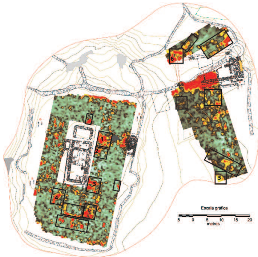
Fig. 23 Plano resumen de las mediciones del Georadar en el área de la iglesia (izquierda) y de la torre-palacio (derecha); los cuadrados representan las áreas investigadas en esta campaña.
