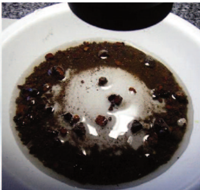
Fig. 8 Rejilla metálica perforada, con adherencias, documentada en el Ambiente 9 (A), disueltas por medios mecánicos y por ultrasonidos (B) (ilustraciones de S. Domínguez-Bella).
