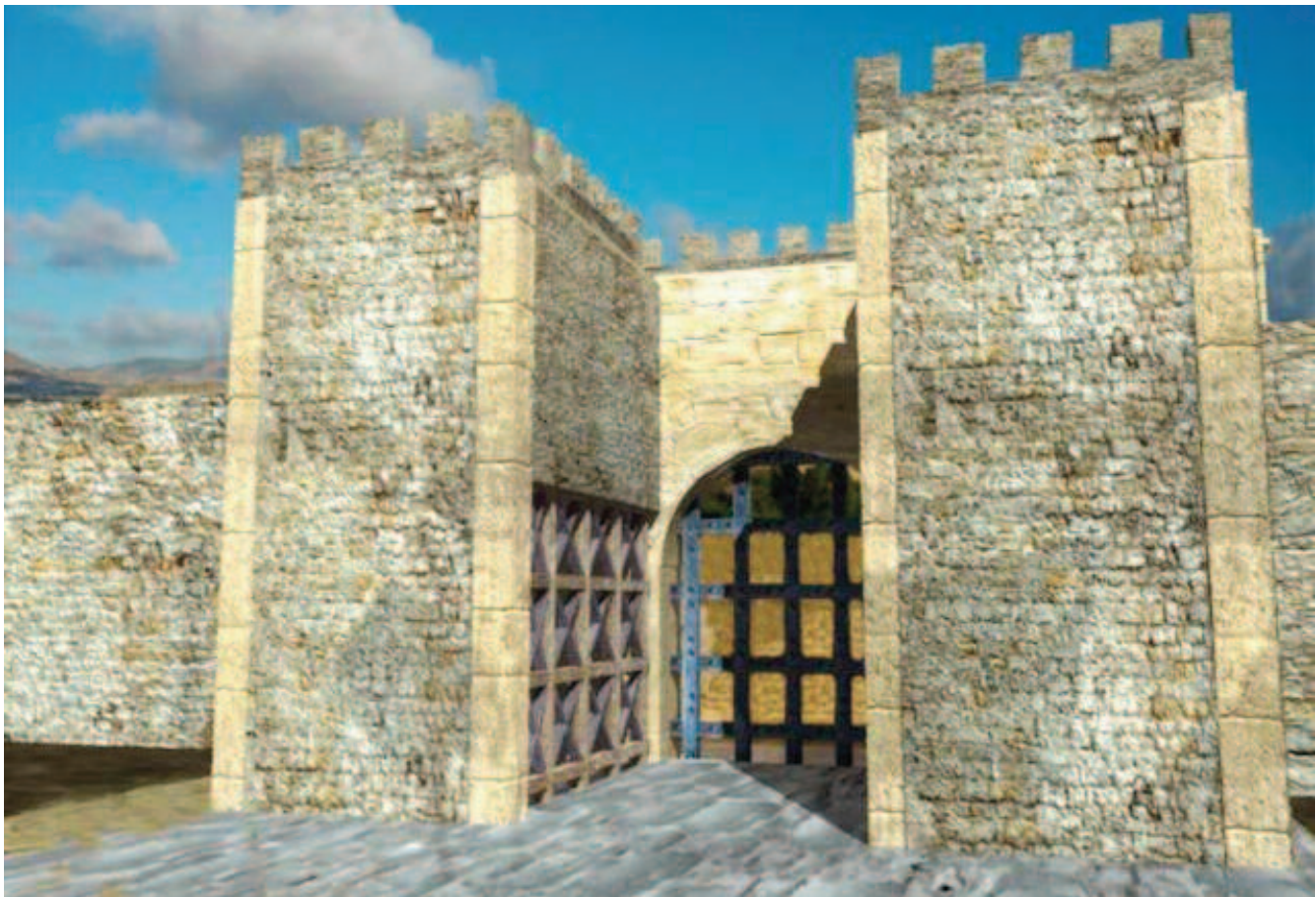
Fig. 7 Reconstrucción infográfica de la segunda fase constructiva. Apréciase el adosamiento de las torres interiores.
