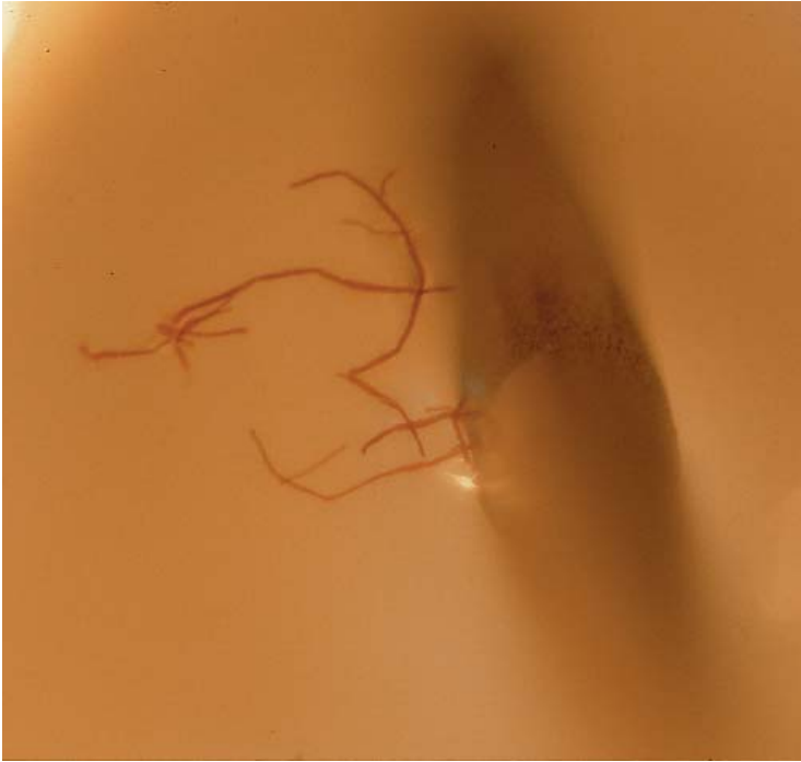
5. Test de temperatura de contracción a nivel de fibra: se aprecia la sonda termométrica y la fibra antes de la contracción al comenzar a calentarse el agua (Foto: Museo del Traje. C.I.P.E.)
