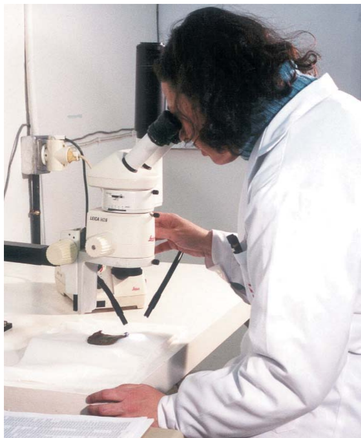
4. Examen y diagnóstico con lupa binocular. Departamento de Conservación Preventiva y Restauración (Foto: MAN)
