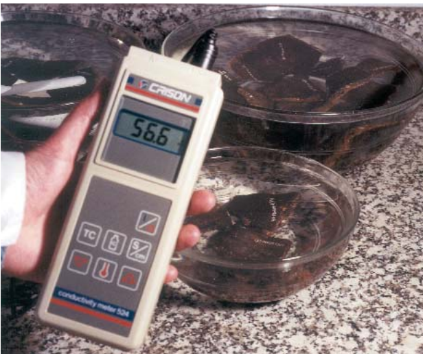
6. Medición de sales solubles mediante conductímetro. Departamento de Conservación Preventiva y Restauración (Foto: MAN)
