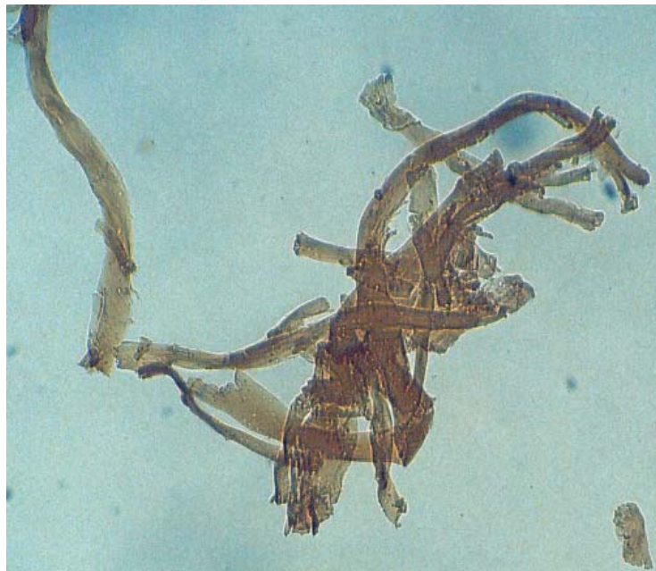
4. Fibras de cuero deteriorado. Se aprecia el colapso fibrilar con pérdida total de la separación de las microfibrillas (Foto: Museo del Traje. C.I.P.E.)
