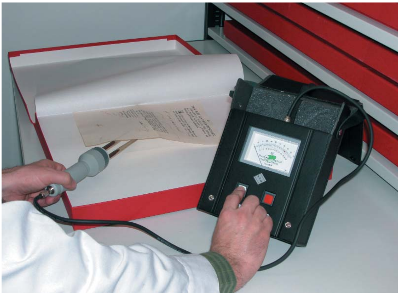
3. Protímetro, aparato que permite medir el contenido en agua en equilibrio en los libros o documentos gráficos (Foto: MNAC)
