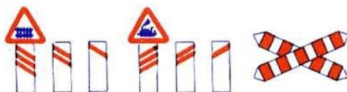
Balizas de acercamiento a paso nivel Con barreras
