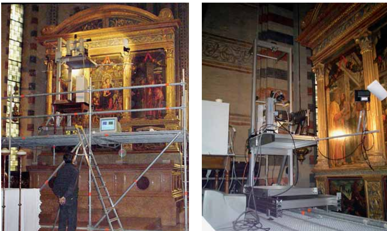
Figure 4. a) L'ampia scaffalatura montata di fronte al polittico di San Zeno; b) la torretta di elevazione del dispositivo riflettografico e il binario.
