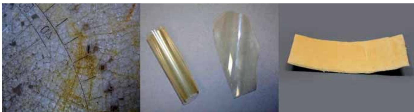
Figura 1. a) Cuarteado de la superficie; b) deformación (curvado) del material y; c) curvado y amarilleamiento.
