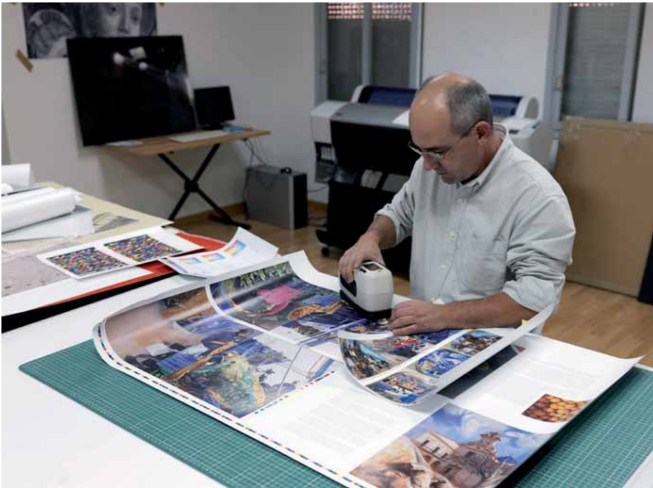
Figura 14. Ajuste de color de las imágenes offset. Pruebas de impresión y pruebas de color son comprobadas con el colorímetro.
