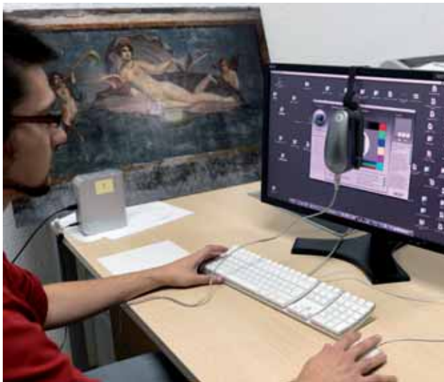
Figura 11. Calibrado del monitor con espectrofotómetro.
