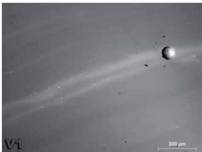
Figura 7. Imagen BSE general de la tesela de color verde transparente V1, donde se observa un bandeo composicional difuso y la presencia de partículas de óxido de estaño que se concentran en los niveles enriquecidos en cobre.
