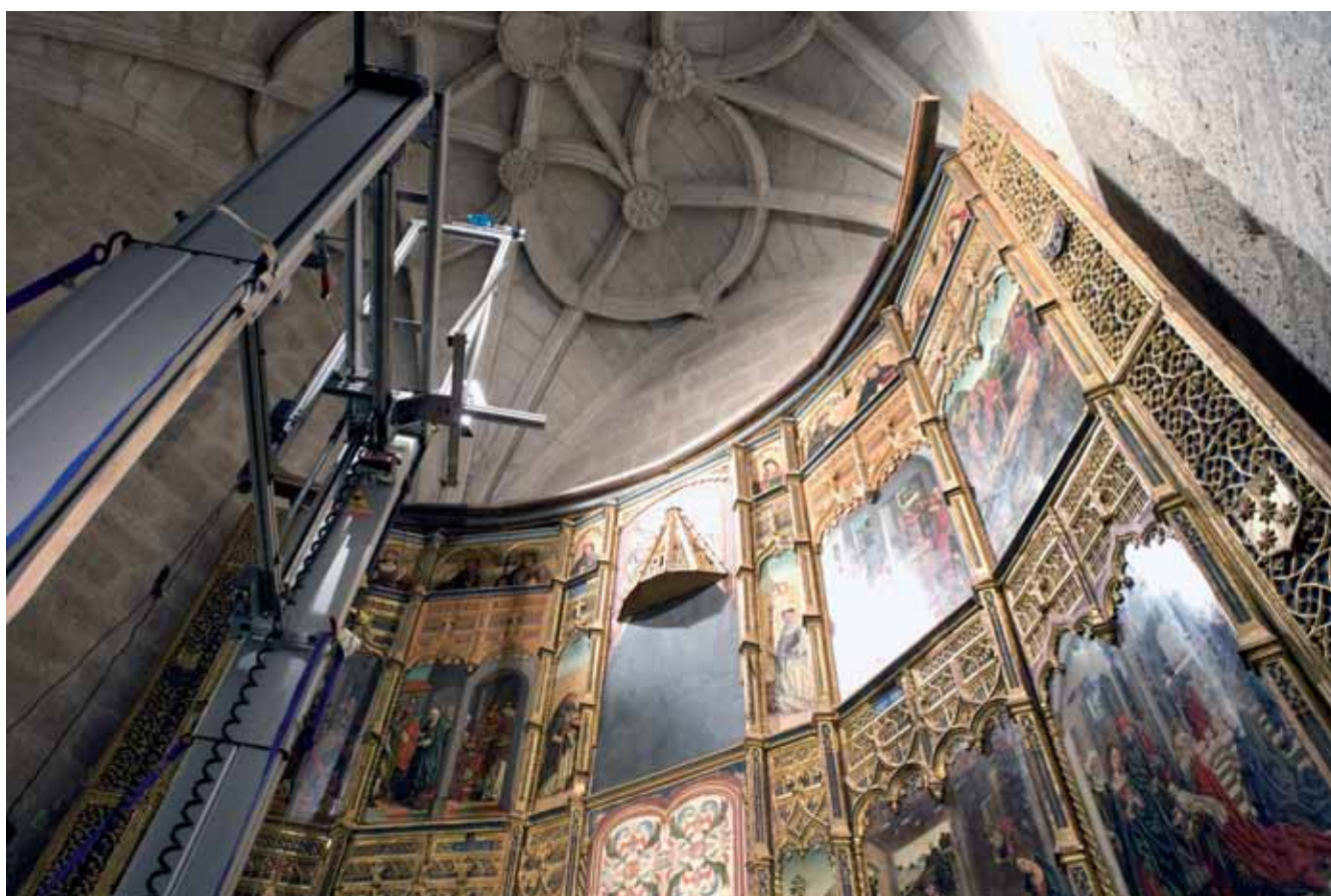
Figura 9. Situación de la cámara Ingaes para la captación de la reflectografía infrarroja en el Retablo de la iglesia de San Lorenzo (Toro).
