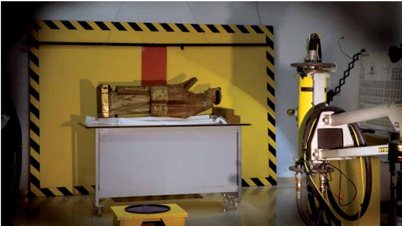
Figura 4. Instalación actual del Instituto. Detalle de la radiografía parcial de una escultura en madera policromada, obsérvese la película de rollo.
