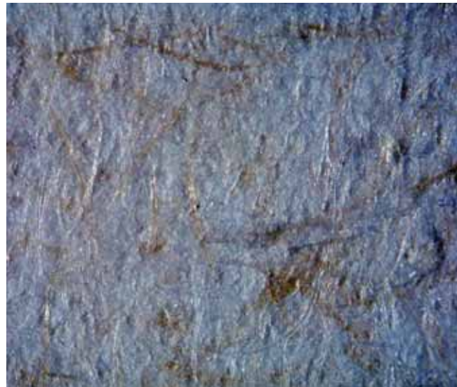
Figura 10. Cartón pluma. Superficie externa. Imagen estereoscópica de un detalle en el que se observan algunas fibrillas con un apreciable amarilleamiento.
