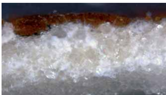
Figura 13. Microfotografía de una muestra del color pardo. Se puede observar la capa de tierras con óxidos de hierro y trazas de negro de huesos sobre una capa de calcita.
