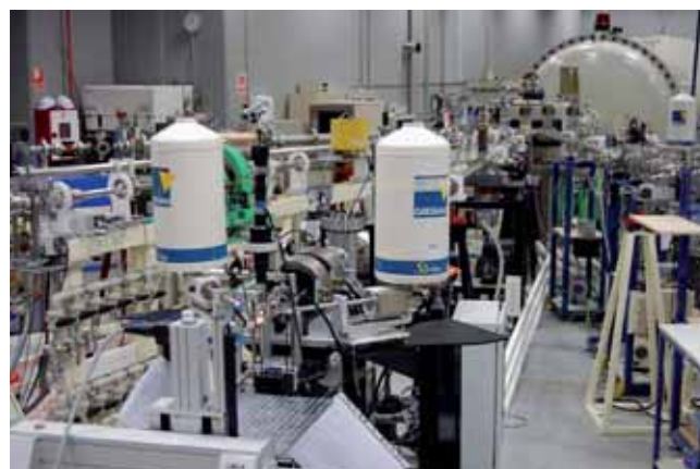
Figura 2. Fotografía de la línea de extensión del acelerador de partículas del CMAM conocida como micro-haz externo.
