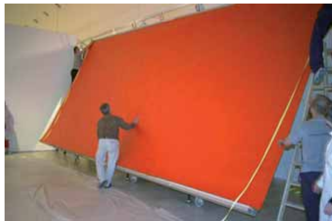
Figura 13. Un momento del montaje de las placas para radiografiar el Guernica.
