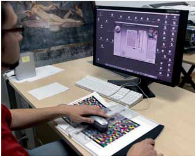
Figura 13. Calibración del papel fotográfico con espectrofotómetro de opacos y parches de color.
