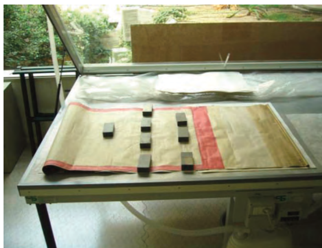
Fig. 16 Cámara de humectación.
