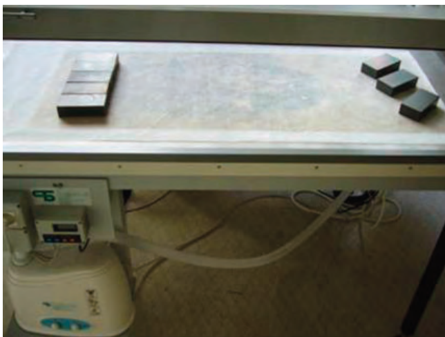
Fig. 17 La obra en la mesa de succión protegida por un soporte sintético.
