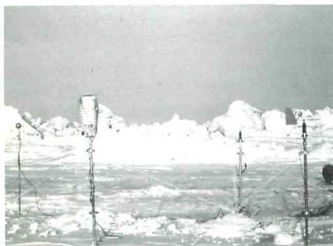
Fotografía 1: En la fotografía superior se observan los instrumentos de detección meteorológicos instalados en la base del PN, en las proximidades también se observa la célula de medida que se ha diseñado para la realización de este trabajo.
