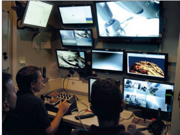
Foto 11. Puesto de operaciones del ROV, instalado en un contenedor en la cubierta del barco.
