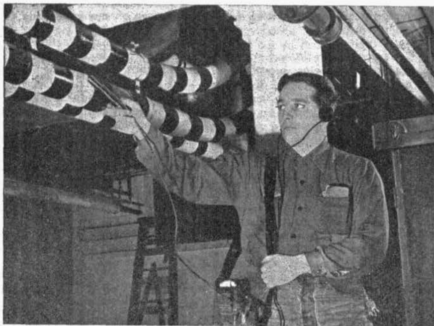
Fig. 7. La exploración radiactiva de una cañería permite controlar el nivel o flujo del fluido que circula por ella y detectar alguna posible «fuga».
